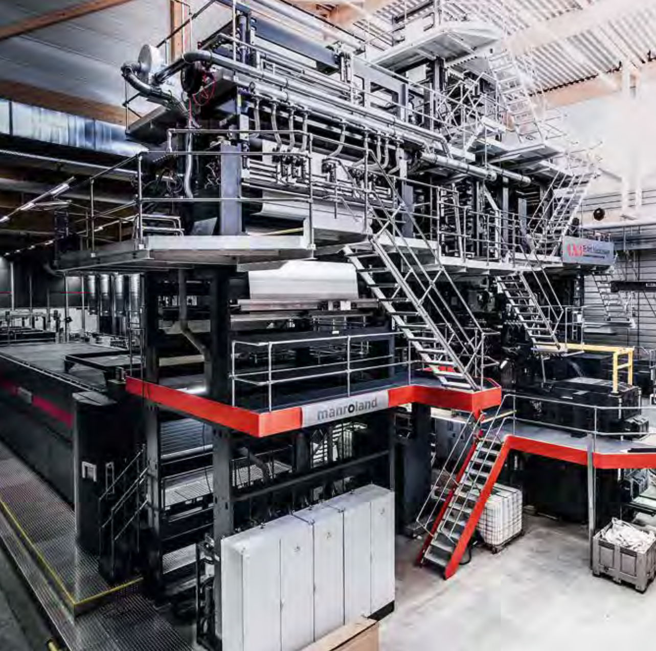
Ein wahres Ungetüm: der Falzapparat der 120-Seiten-Rollenoffsetmaschine, die mit einer Papierbahnbreite von 286 Zentimetern täglich 180 Tonnen Papier bedruckt.
