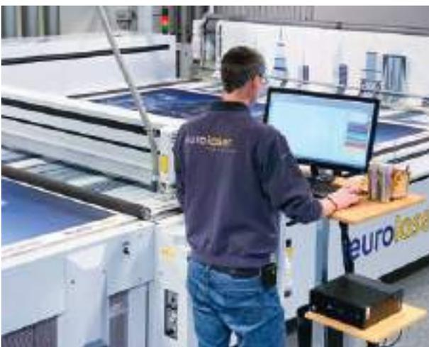
geschnitten. Im Gegensatz zu anderen Bearbeitungsverfahren wird der Laser im Zeitablauf nicht stumpf. Die Qualität der Schnitte bleibt über Jahre konstant hoch, vom ersten bis zum letzten Werkstück.
